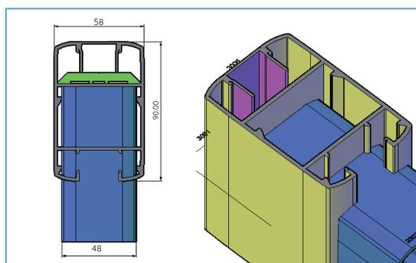
Assemblage par double mortaise, plat de renfort et vis inox pour une excellente rigidité.
